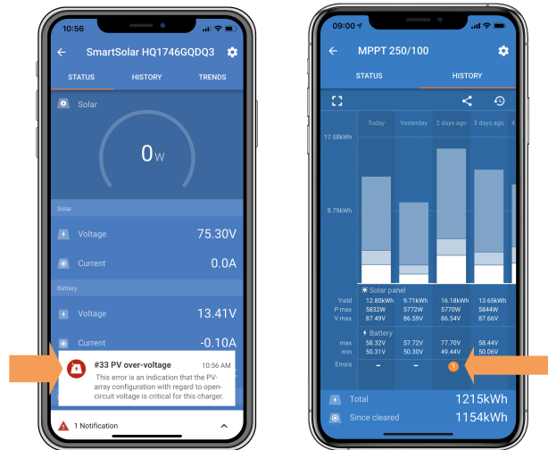
VictronConnect-sovellusvirhe #33 tilanäytöllä ja historiatiedoissa.
